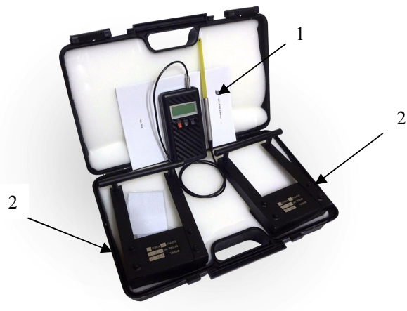
Рис.5.1. Размагничивающий комплект РК-02 1- магнитометр универсальный, 2 - магнитные компенсаторы.
