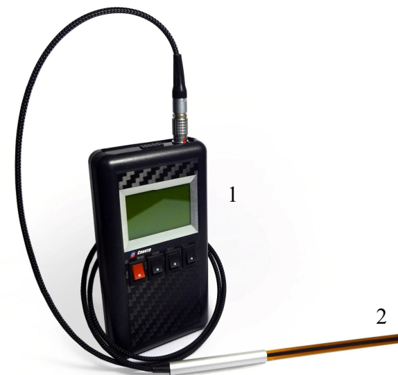
Рис.3.2. Внешний вид универсального графического магнитометра
