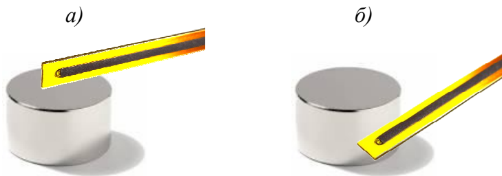
Рис.3.7. Измерение тангенциальной составляющей вектора индукции магнитного поля на торцевой (а) и боковой (б) поверхности стального изделия.
