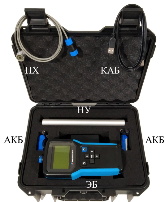
Рис.3.2. Внешний вид индикатора механического напряжения металла ИИ-01м в комплекте
